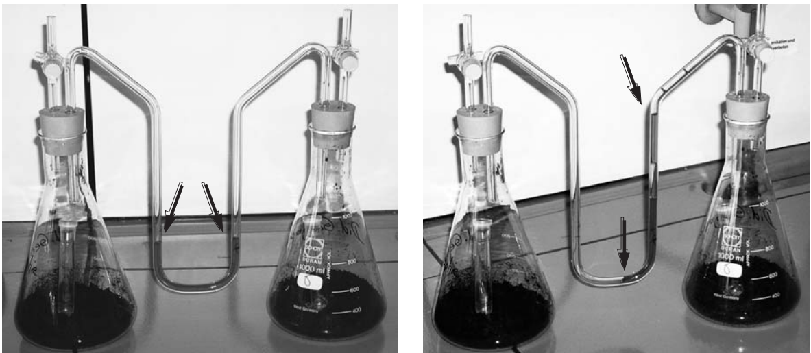
F30 | Links: Versuchsbeginn des U-Rohrexperiments: Flüssigkeit in der Mitte des Rohres.
