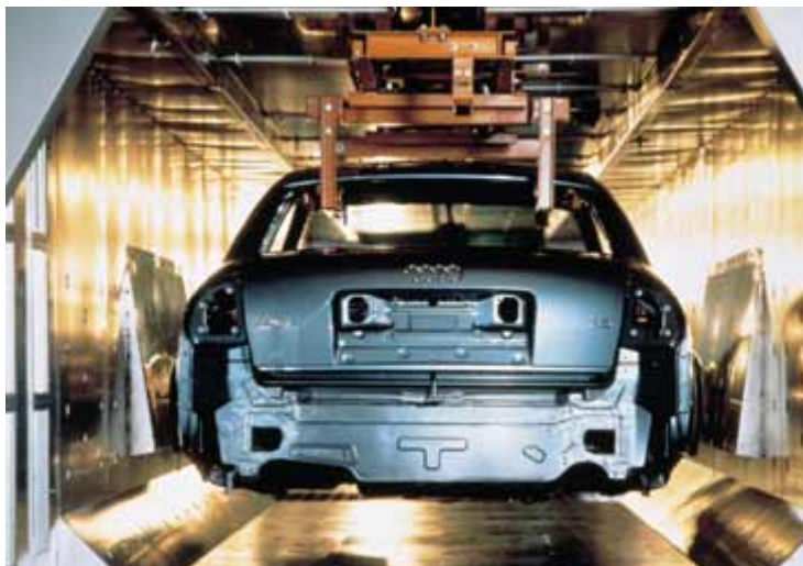
In der Lackiererei: Zur Vorbereitung auf die Heißwachsflutung wird die Karosserie vorgewärmt.
