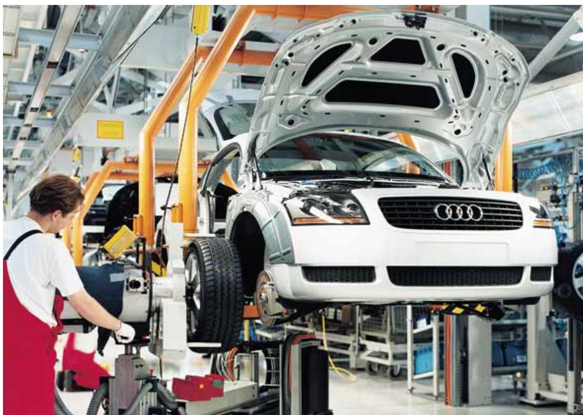
Letzter Fertigungsschritt ist die Montage von Rädern, Sitzen und Stoßdämpfern
